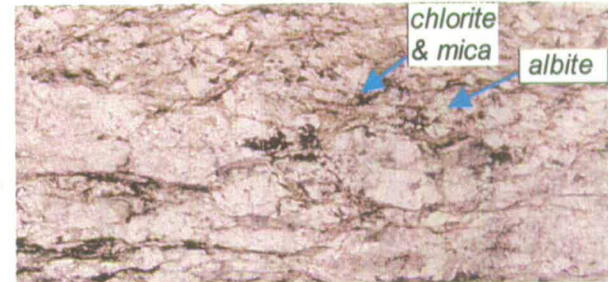
cataclastic fault gouge
